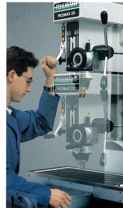
La tête porte-broche est réglable en hauteur par une manivelle. Un guidage précis empêche tout pivotement de la tête sur la colonne, ainsi une précision de répétition de  $\pm 0,01$  mm est garantie pour le positionnement X/Y de la broche.
