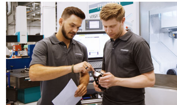
Michael Maurer (à droite, chef de projet Fabrication d'outils) et Elias Wermuth (responsable Fabrication d'outils) inspectent un insert de moule d'un outil de moulage par injection.
