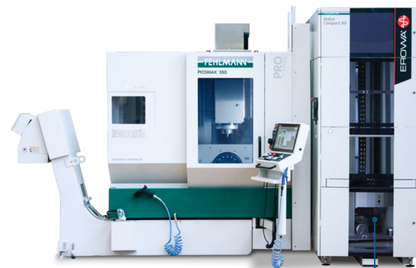
Sur demande, une automatisation pour la manipulation des palettes ou des pièces est également disponible pour la version PRO. Les solutions d'automatisation flexibles de FEHLMANN augmentent la productivité et peuvent être installées à tout moment.
