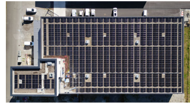
Die neue Photovoltaikanlage mit einer Leistung von 320 kWp auf dem Dach des Neubaus «Gebäude 4».
