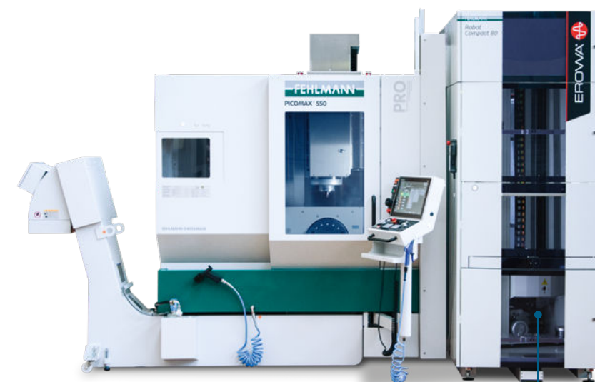
Auf Wunsch ist für die PRO-Version auch eine Automation für das Paletten- oder Teilehandling erhältlich. Die flexiblen FEHLMANN-Automationslösungen steigern die Produktivität und sind jederzeit nachrüstbar.
