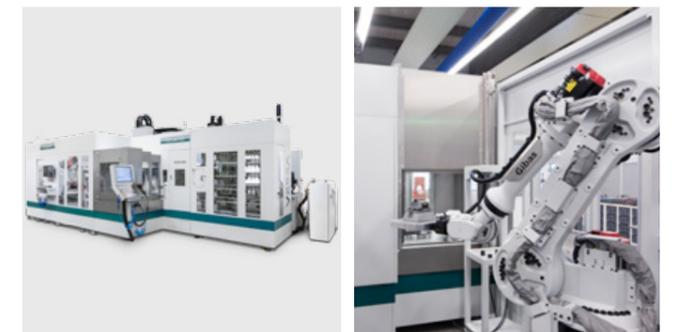
Robot à bras articulé Gibbs et système de gestion des tâches Soflex sur la VERSA 825
