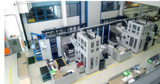
Solution d'automatisation linéaire composée de deux VERSA 825 avec magasins à rayonnage pour 346 outils maximum
