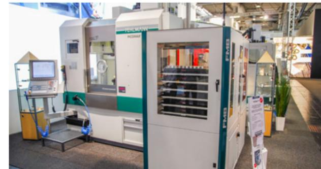
Robot à bras articulé FMB pour la manipulation des pièces brutes sur la PICOMAX 75
