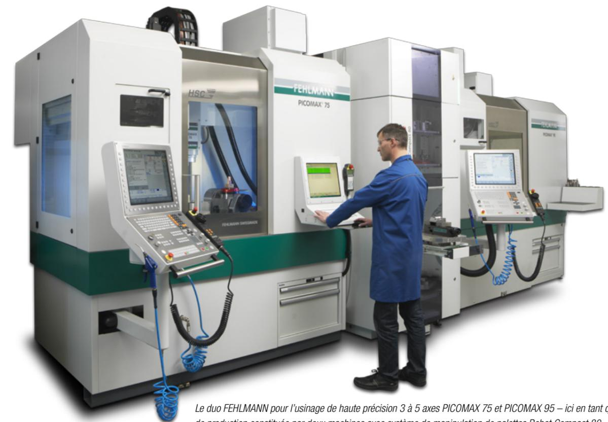
Le duo FEHLMANN pour l'usinage de haute précision 3 à 5 axes PICOMAX 75 et PICOMAX 95 – ici en tant qu'installation de production constituée par deux machines avec système de manipulation de palettes Robot Compact 80
