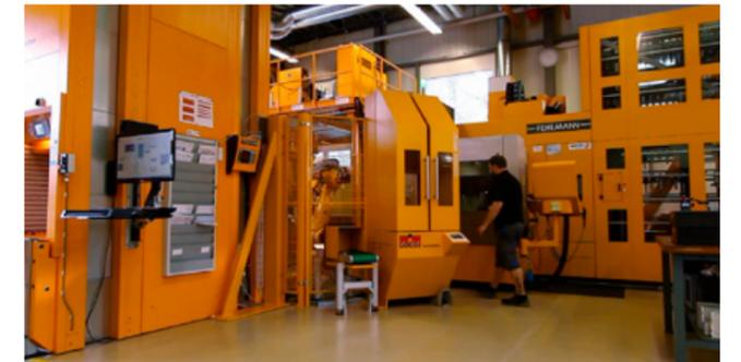
Robot à bras articulé et système d'automatisation Goodj sur la VERSA 825 avec magasin à rayonnage pour 346 outils
