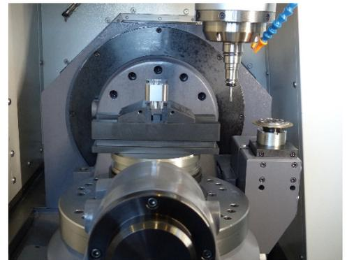
*Der Schleifstift sitzt im Rotationszentrum der Spindel und führt die Oszillationsbewegung durch.*
