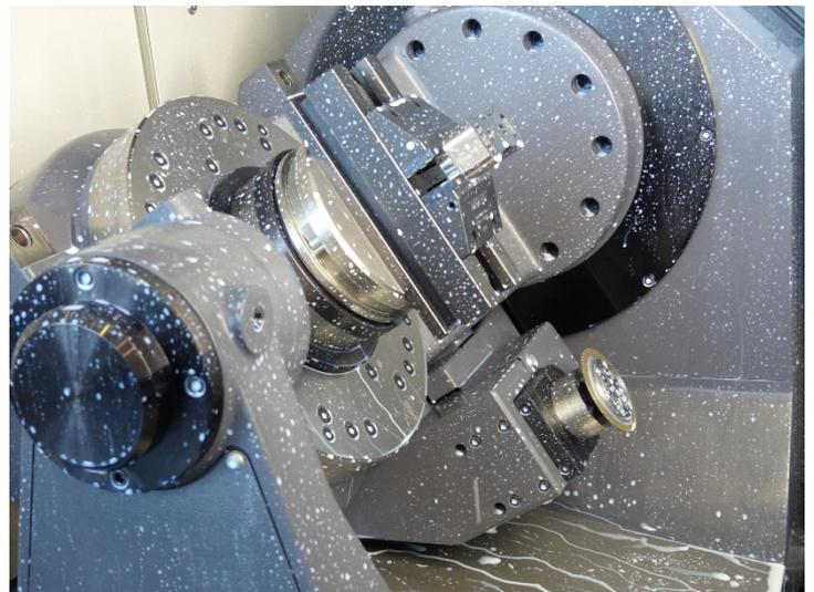
*Diese Abrichtspindel ist schwenkbar, der 5-achsige Arbeitsraum wird dadurch nicht eingeschränkt.*
