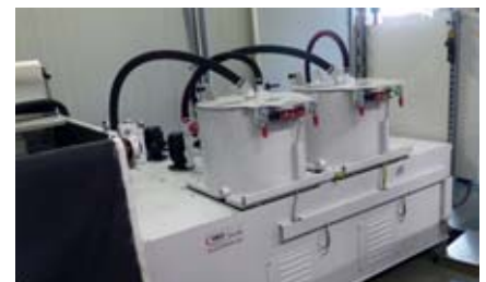
Das Kühlmittel wird zunächst grob vorgefiltert, läuft dann über einen Bandfilter und in die Fliehkraftfilter.
