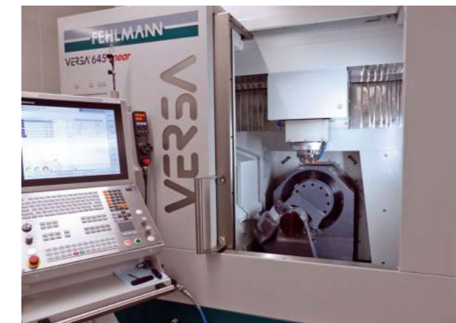
2 Mit dem 5-Achs-BAZ 'Versa 645 linear' von Fehlmann ist es gelungen, eine Präzision von 0,5 µm sicherzustellen und damit enorm Kosten einzusparen © Fehlmann
