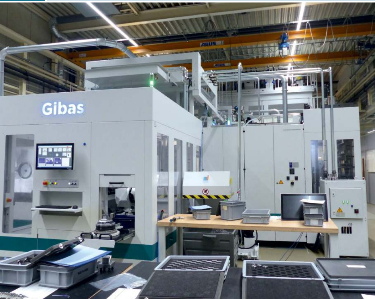
1 Bei der Fertigungsanlage mit vier Bearbeitungszentren Versa 645 linear von Fehlmann wollte man nicht in Maschinen oder eine Anlage investieren, sondern in stabile Prozesse © Fehlmann
