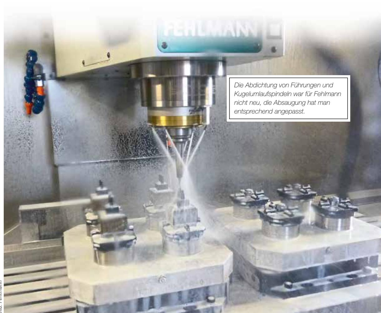
*Die Abdichtung von Führungen und Kugelumlaufspindeln war für Fehlmann nicht neu, die Absaugung hat man entsprechend angepasst.*
