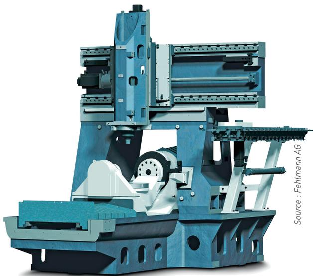
*Le bâti de la Fehlmann Versa 825 est en fonte grise et fait appel à la simulation par éléments finis pour assurer la meilleure stabilité possible. La position du berceau perpendiculaire au portique est parfaitement visible sur cette image.*
