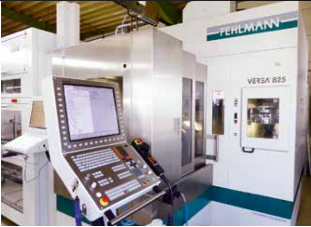
1 Ungeplant kommt oft: Anstelle einer alleinstehenden Maschine zur 5-Achs-Bearbeitung verrichtet heute bei G. & K. Schön ein 5-Achs-Simultan-Bearbeitungszentrum Versa 825 von Fehlmann inklusive Erowa-Automatisierung seinen Dienst (© Fehlmann)
