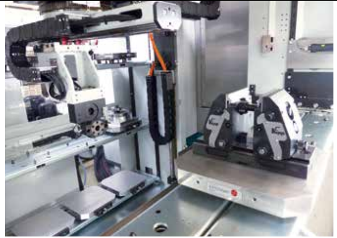
2 Der Erowa-Roboter Leonardo nimmt im Standard bis zu 24 UPC-Paletten der Abmessung 320 mm x 320 mm auf und ermöglicht mit einer Be- und Entladeschublade hauptzeitparalleles Rüsten (© Fehlmann)
