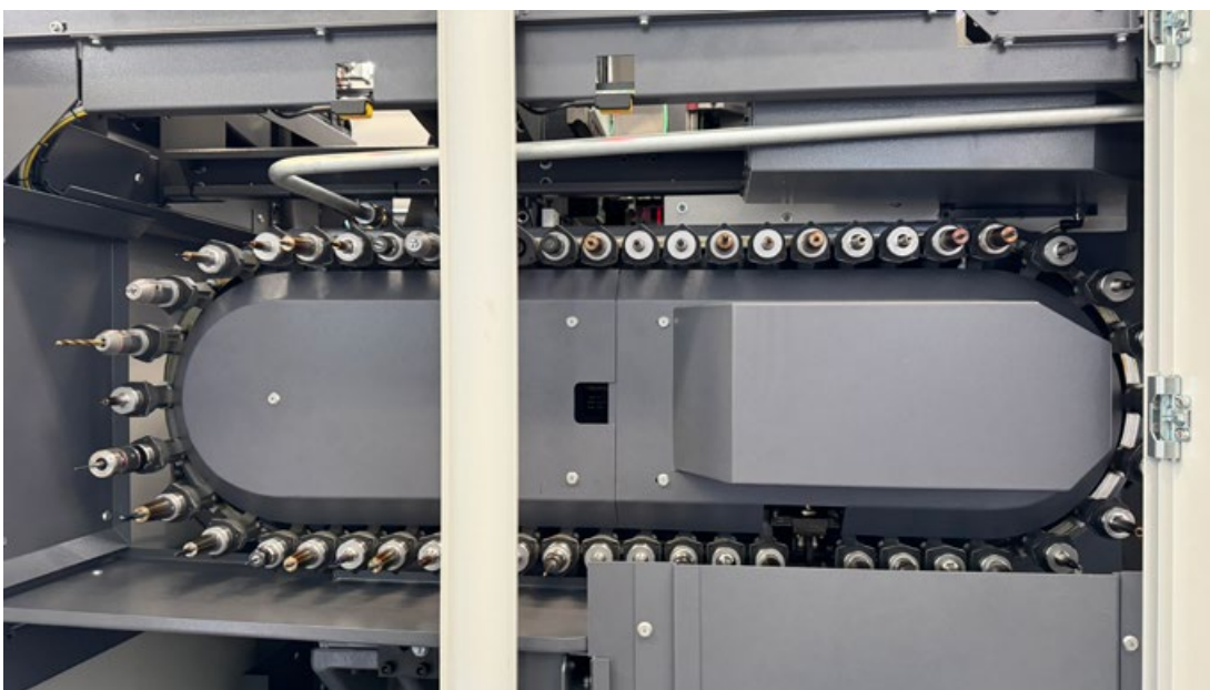
Der Werkzeugwechsler mit Kettenmagazin bietet in der Grundausführung Platz für 50 Werkzeuge, optional für 86 Werkzeuge und mit Regalmagazin bis über 400.
