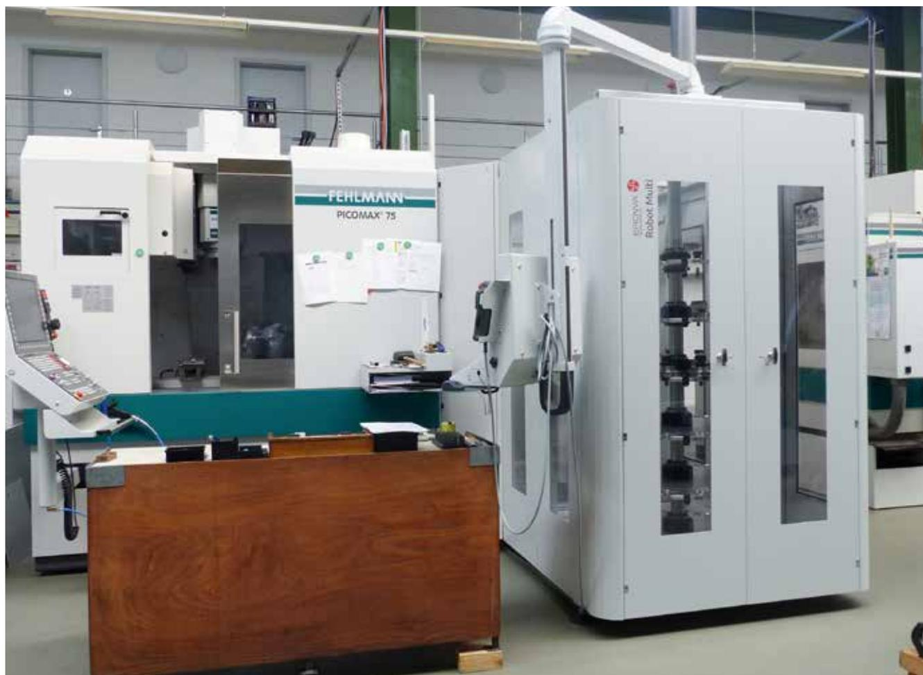
Mittlerweile sind es insgesamt **15 Fehlmann-Bearbeitungszentren**, überwiegend mit fünf Achsen, in insgesamt sechs automatisierten Fertigungszellen.
